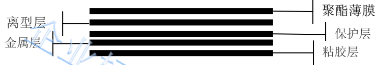
图一：烫金类印件结构层
